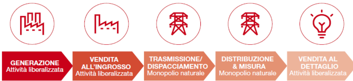
Figura 4 – Filiera dell'energia elettrica
